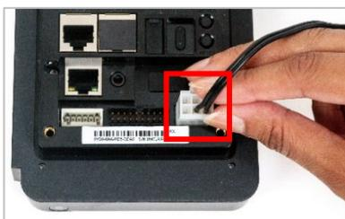
débranchez le connecteur du câble d'alimentation du port esclave MDB situé à l'arrière du terminal Moneris Go sans surveillance.
