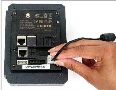
4. Branchez le connecteur du câble d'alimentation dans le port esclave MDB situé à l'arrière du terminal IM30.
