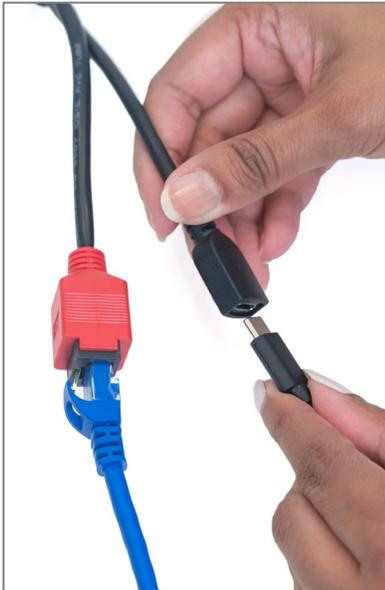
4. Branchez le câble USB-C et l'adaptateur d'alimentation c.c. au port USB-C femelle relié au câble d'alimentation et de réseau.
