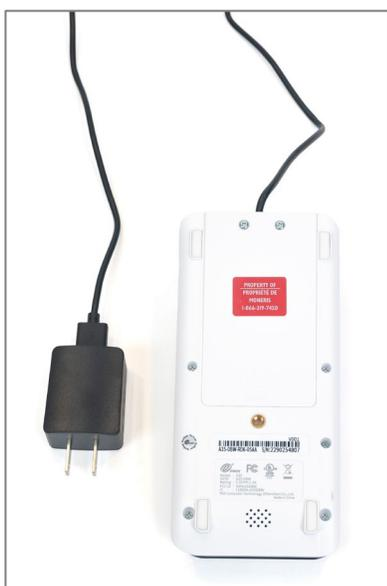
3. Remettez en place le couvercle de la pile et les vis à l'aide d'un tournevis. Assurez-vous que l'autre extrémité du câble est bien branchée dans l'adaptateur c.c.
