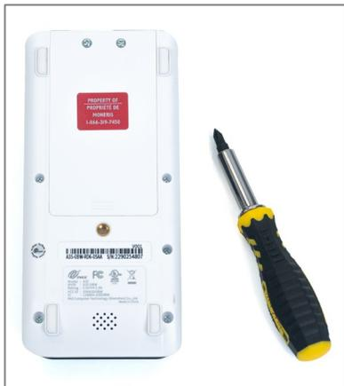
1. À l'aide d'un tournevis, retirez les deux vis situées au haut du couvercle.
