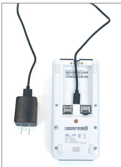
2. Insérez le câble USB-C dans la prise USB-C de l'appareil. Veillez à ce que le fil soit placé correctement à l'intérieur des guides situés près de l'extrémité supérieure de l'appareil.
