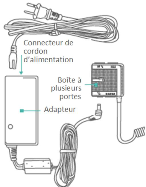
3. Branchez l'autre extrémité du câble sur la source d'alimentation. Le terminal s'allumera.
