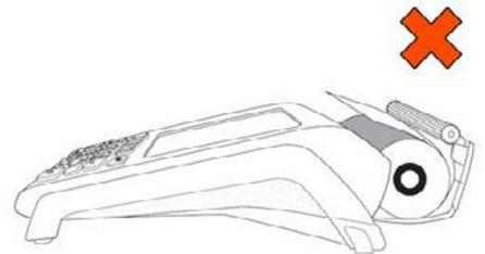
4. Refermez fermement le couvercle en appuyant dessus de telle sorte que le papier qui dépasse se retrouve entre le couvercle fermé et le dessus du panneau avant.
