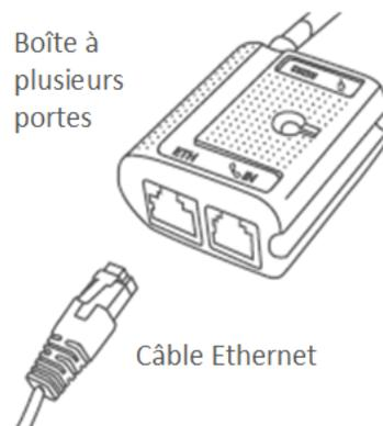
2. Branchez l'autre extrémité du câble Ethernet sur le routeur, le commutateur, le concentrateur, le câblage interne, ou peu importe ce qui vous permet d'accéder au service Internet haute vitesse à votre emplacement. (Au besoin, consultez la **Liste de vérification pour la préparation de la connexion Ethernet.**)
