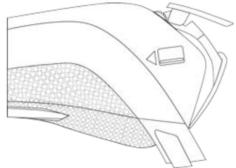
2. Insérez le rouleau de papier dans le compartiment de telle sorte qu'il se déroule du haut du rouleau vers l'arrière du terminal.
